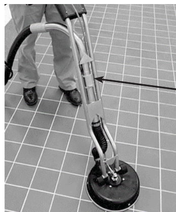
Cubierta del freno de aspiración
